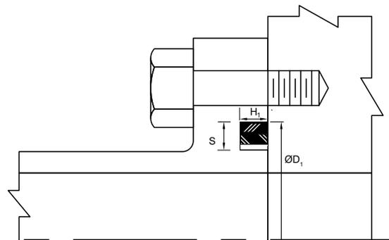
**Les joints de bride PFS/SFS** sont conçus pour remplacer les joints toriques utilisés dans les brides à 4 boulons selon le standard SAE J518C. Ce joint en polyuréthane offre une durée de vie accrue, une meilleure tenue à l'extrusion et une grande facilité d'installation.
