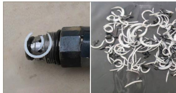
Les contre-joints en PTFE se font pincer et cassent lors de l'installation, causant des fuites prématurées
